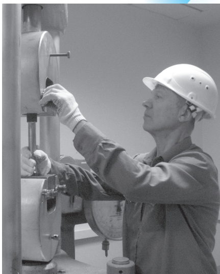
Проверка качества сварного соединения на испытательном стенде
