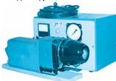
Рис 1.4 Металлизатор ЭМ-17.
