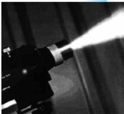
Рис. 1.6. Вид распыляющей струи в ЭДМ-аппарате ARCJET GUN (США).
