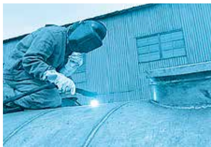
Рис. 6. Ручная плазменная резка алюминиевой железнодорожной цистерны: начало и окончание резки.
