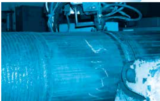
Рис. 5. Плазменная наплавка током обратной полярности оправки из стали 08X18H10.
